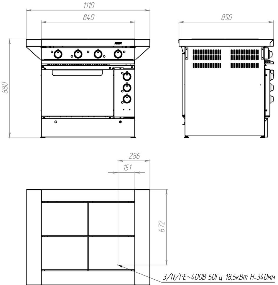
Рис.9 Габариты и схема подключений ЭПШЧ-9-4-18-06.
