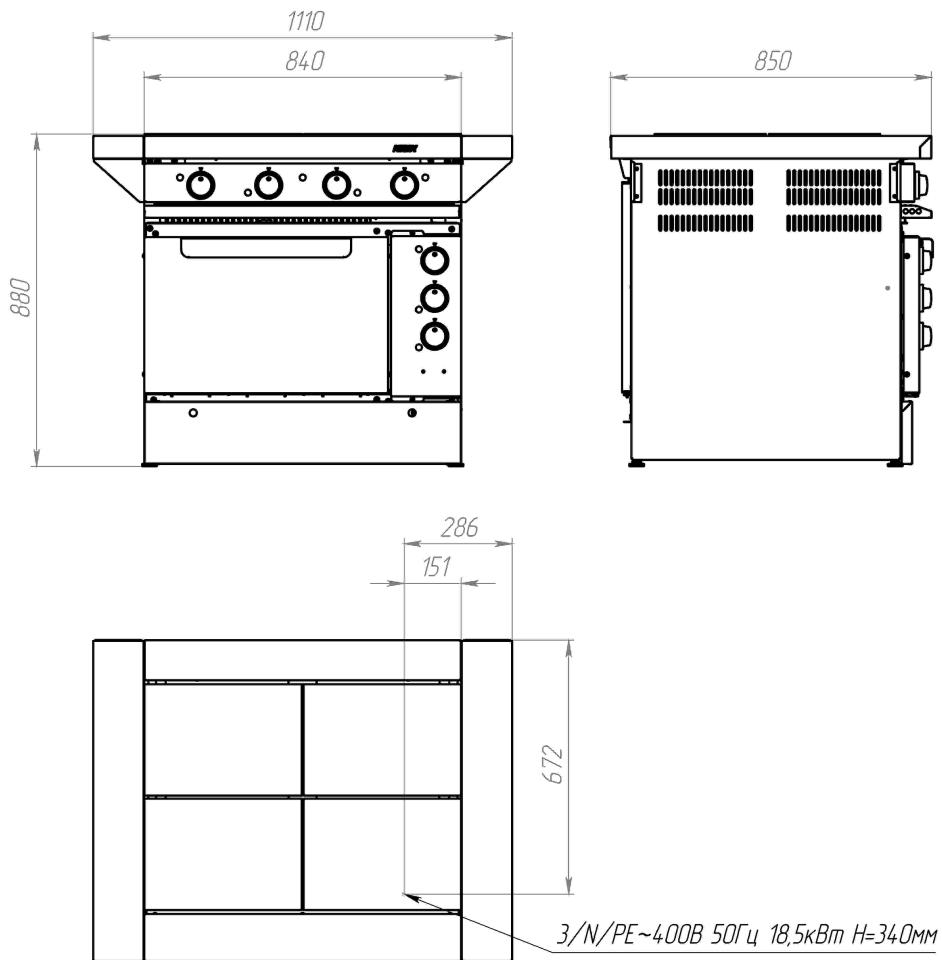
*Рис.9 Габариты и схема подключений ЭПШЧ-9-4-18-06.*
