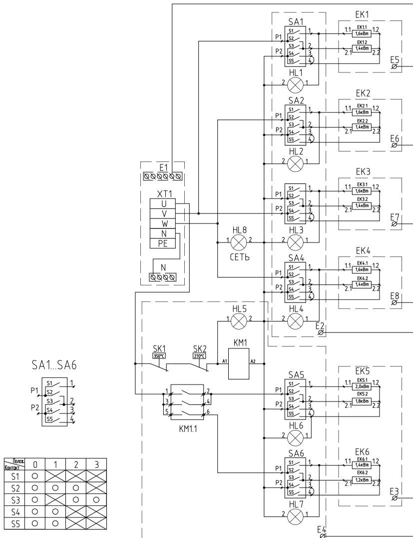
Рис.7 Схема электрическая принципиальная ЭПZh-9-4-18-06.
