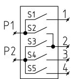
Рис.8 Схема электрическая принципиальная ЭПЧ-9-4-12-06.
